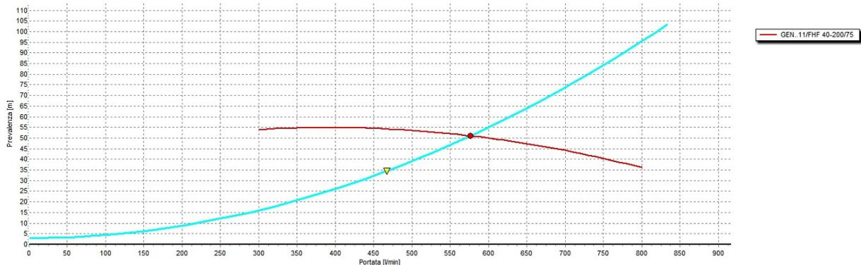
Dato il valore di portata massima richiesta dall'impianto, la riserva idrica necessaria a garantire una durata di funzionamento di **60.00 min** è **29.00 m<sup>3</sup>**.
